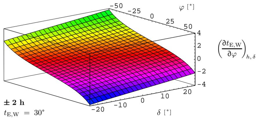
**Abb. 4** Fehlerverstärkung der Breitenänderung für verschiedene „Abstände“ zum Meridiandurchgang
