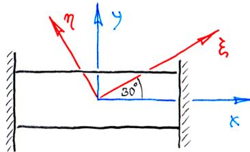
Für den Fall einer gleichmäßigen Erwärmung um  $\Delta\vartheta$  kann von einem gleichförmigen Spannungs- und Dehnungszustand über dem Körpervolumen ausgegangen werden. Man berechne für diesen Fall
